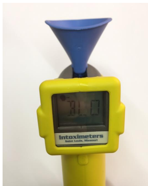
ภาพที่ 1 เครื่องเป่าสำหรับวัดปริมาณแอลกอฮอล์ในลมหายใจ
