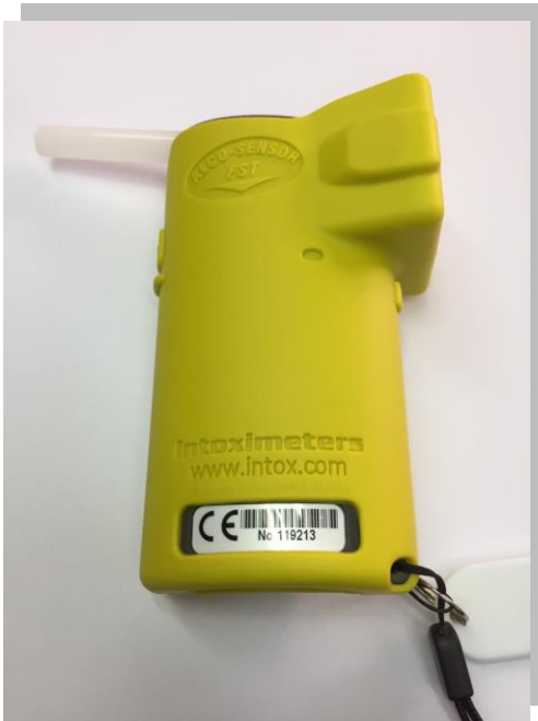
ภาพที่ 1 เครื่องเป่าสำหรับวัดปริมาณแอลกอฮอล์ในลมหายใจ
